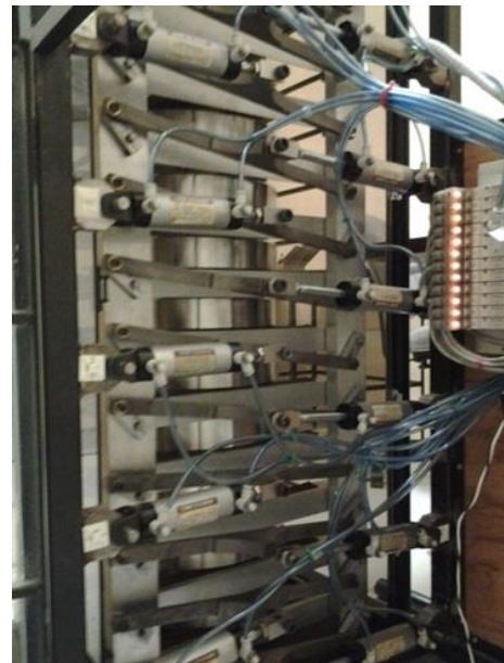
Sistema de control del Patrón Nacional de Fuerza, hasta 2.5 kN
